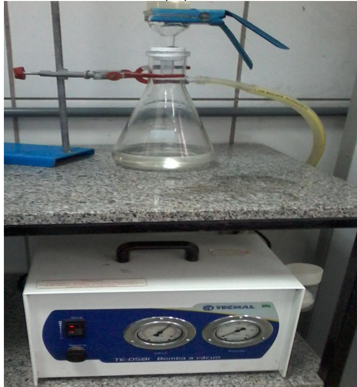
Figura 7: Sistema de filtração à vácuo utilizado para filtração das amostras. Fonte: próprio autor
