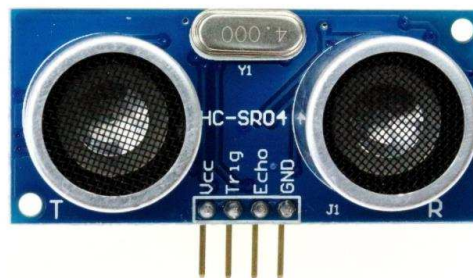
Figura 45 – Sensor ultrassônico HC-SR04.
