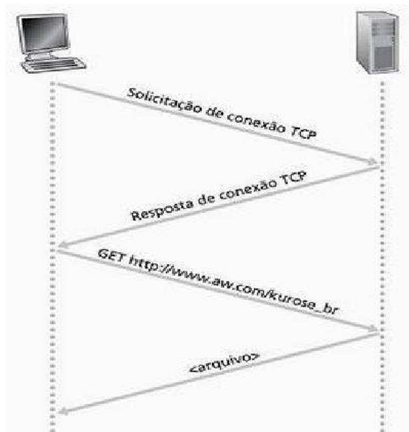
Figura 15 – Movimentação de envio e resposta de solicitações entre o cliente e o servidor.
