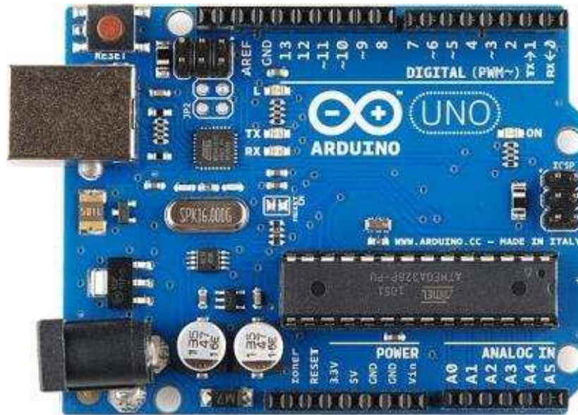
Figura 23 – Pinos de saídas do PWM com o caractere ‘~’.
