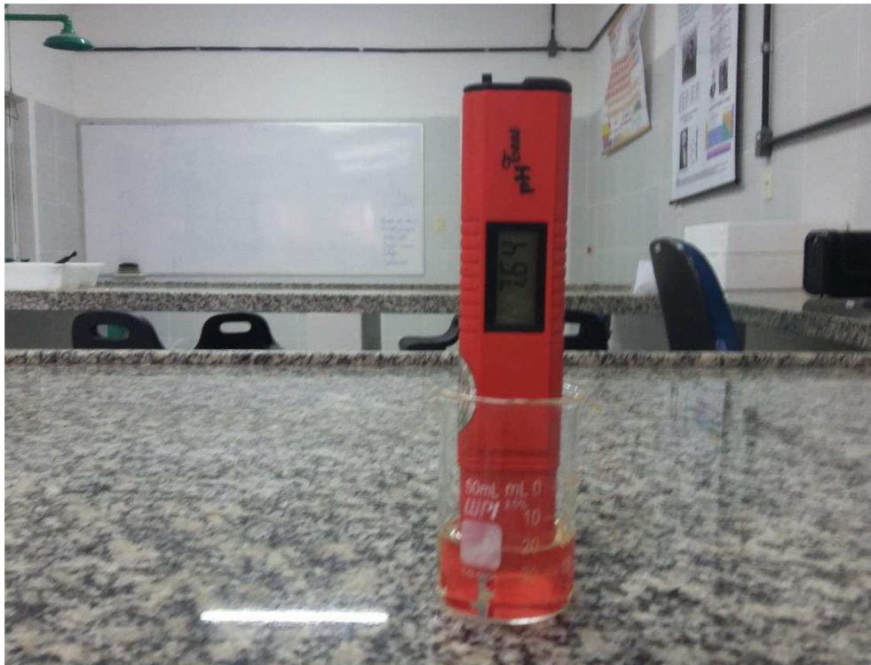
Figura 5 – Medidor de pH Digital portátil ITPH- 2000 aferindo a acidez da gasolina.
