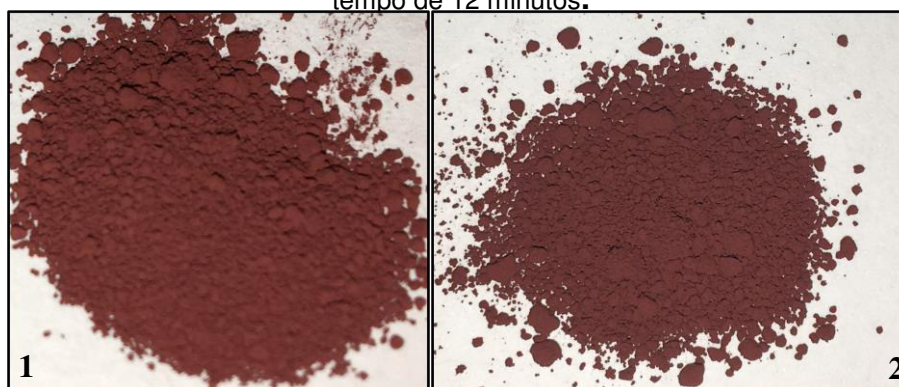
Figura 21- Precipitados obtidos pelo método hidrotermal via micro-ondas (1) tempo de 4 minutos; (2) tempo de 12 minutos.
