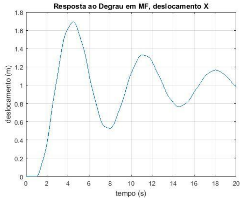
Figura 32 - Resposta ao degrau da posição X em malha fechada.
