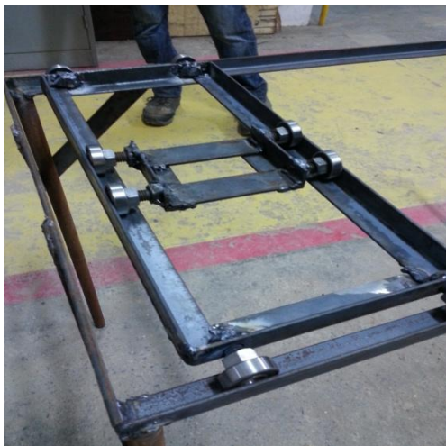
Figura 46 – Estrutura de ferro do trilho e carro em detalhe.
