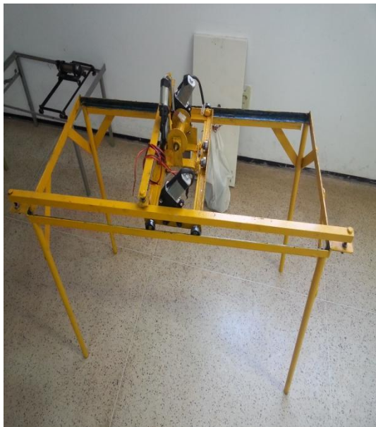
Figura 48 – Estrutura da ponte rolante finalizada.
