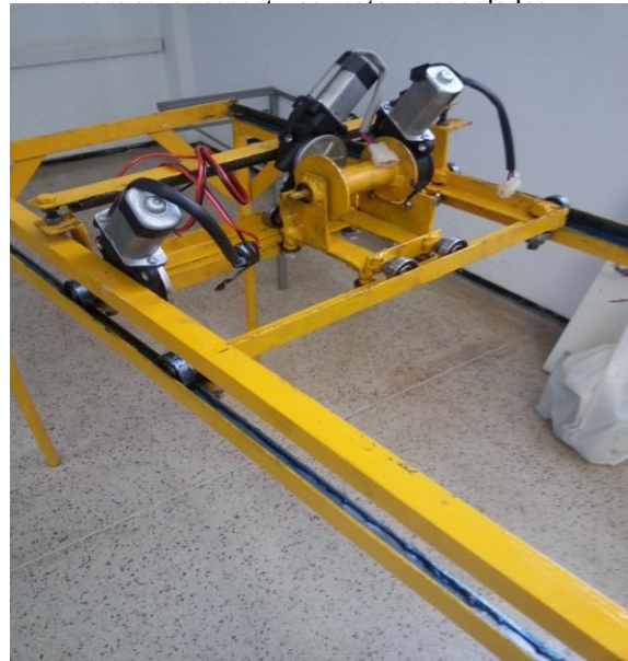
Figura 49 – Detalhe do conjunto trilho, carro e tambor, com motor e sistema de transmissão.
