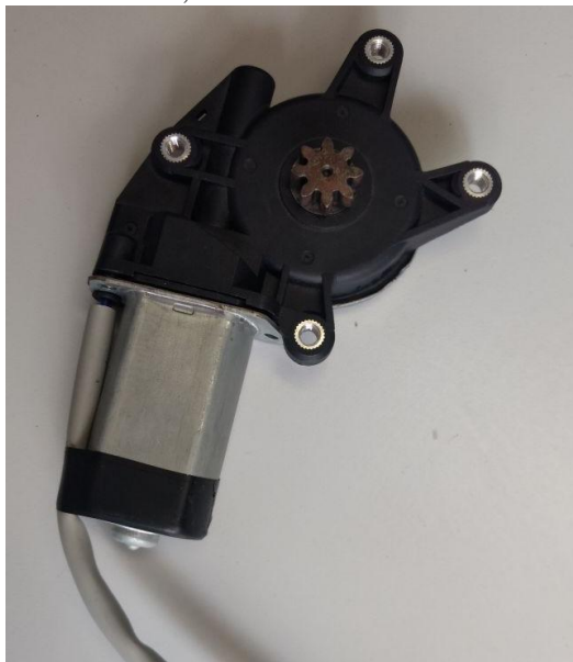
Figura 52 – Motor CC, atuador do movimento nos eixos X e Y.
