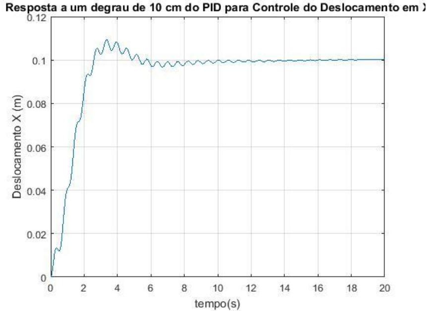
Figura 39 - Resposta ao degrau de 10 cm do PID 1, deslocamento em X.
