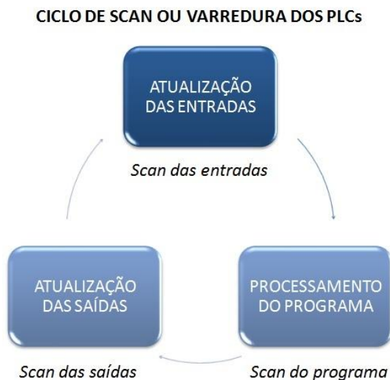
Figura 7 - Ciclo de SCAN de um CLP.
