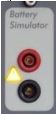
Figura 22 - Saída de tensão contínua para simulação de baterias.
