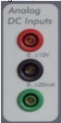
Figura 23 - Entrada para medição de tensão ou corrente.
