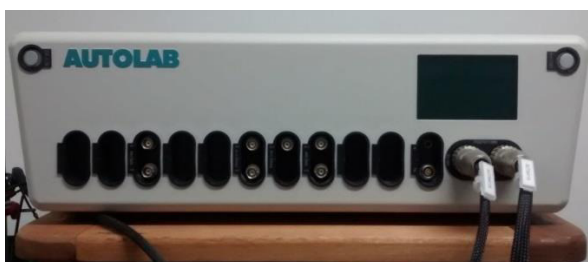
Figura 3 - Potenciostato/galvanostato da AUTOLAB ® utilizado nas medidas eletroquímicas
