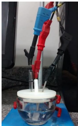
Figura 4 - Célula eletroquímica utilizada nos testes VC e EIE.
