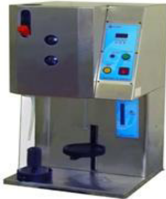
Figura 3: Aparelho destilador para determinação de nitrogênio total
