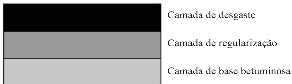
Figura 11 – Estrutura de pavimento em base betuminosa
