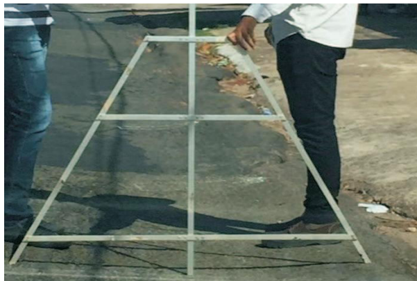
Figura 44 – Treliça metálica para medição dos afundamentos
