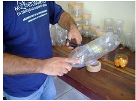
Foto 10 – Corte das peças das armadilhas. Fonte: Registro primário de campo, 2008.
