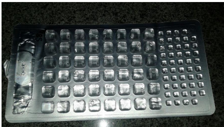
Figura 9. Resultados da coloração dos poços no Quanti-Tray após 24 horas de incubação.
