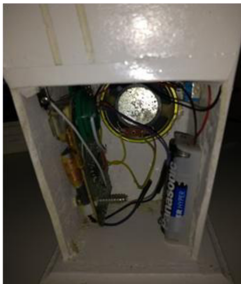
Figura 7: Placa de rádio, pilha e amplificador acoplados na estrutura do rádio.
