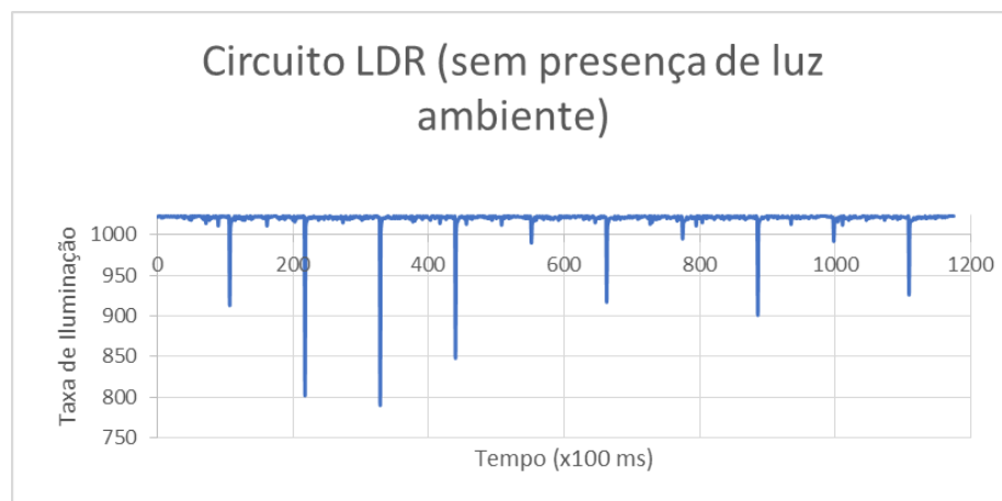
Figura 3.9 – Resultado teste medidor sem iluminação ambiente. Fonte: Elaborado pelo autor.
