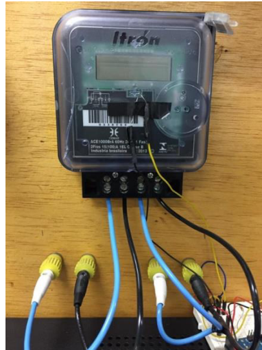
Figura 3.4 – Posição do sensor LDR no medidor. Fonte: Elaborado pelo autor.
