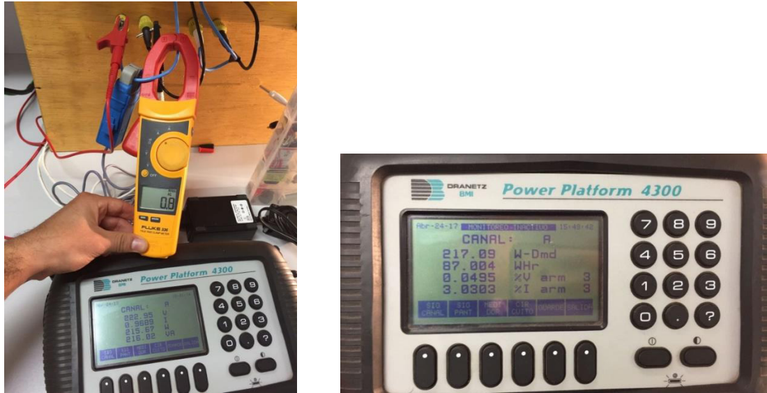
Figura 3.7 – Detalhes e resultado parcial do teste de calibração. Fonte: Elaborada pelo autor.
