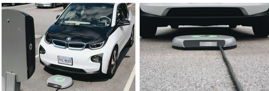
Figura 9 – Carregamento indutivo adaptado para o BMW i3
