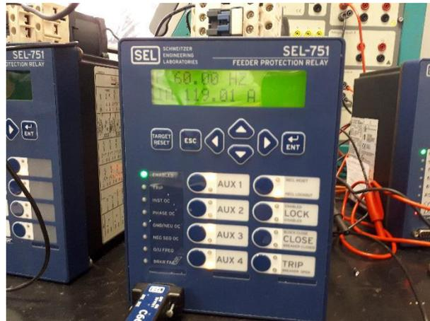
**Figura 31: Leitura de Frequência e Corrente no relé**
