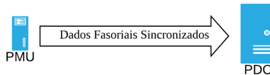
Figura 43. Arquitetura cliente-servidor simples para comunicação entre o PMU e o PDC.
