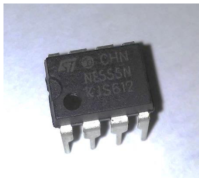
Figura 34. Oscilador NE555 (Fonte: Autor).
