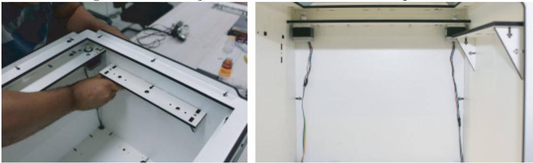
Figura 4.10: Fixação da estrutura interna da impressora
