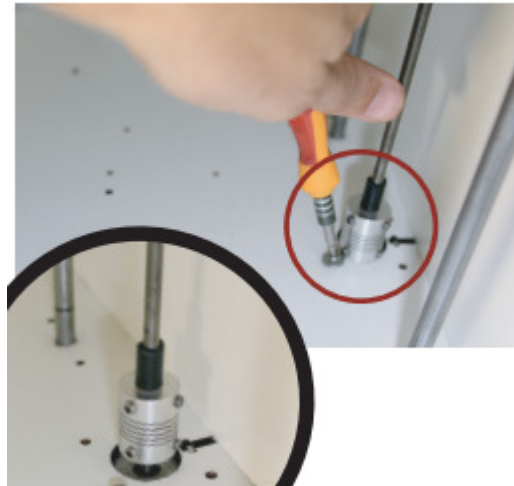
Figura 4.15: Detalhes da fixação do motores.
