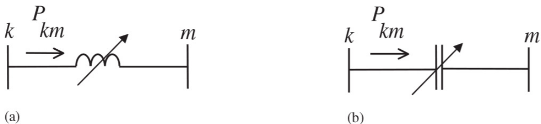
Figura 21 – Circuito equivalente do TCSC operando na região (a) indutiva e (b) capacitiva.
