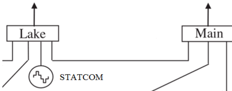
Figura 36 – Inclusão do STATCOM no sistema de 5 barras.
