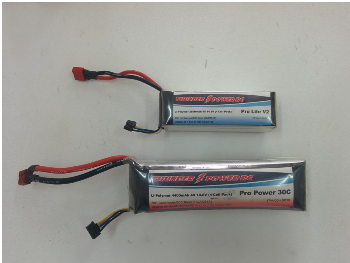
Figura 36 – Baterias de LiPo utilizadas nos experimentos com o robô.
