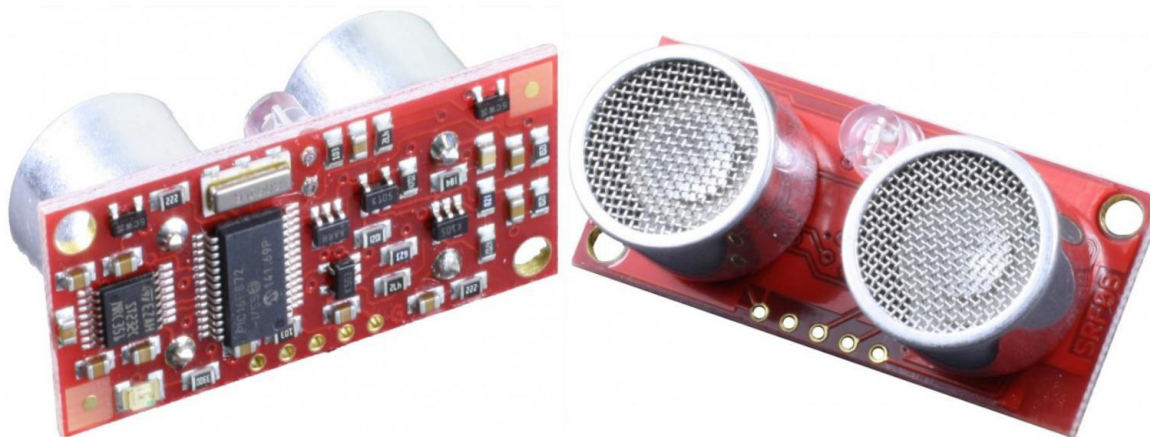
Figura 28 – Sonar SRF08 destacando seu circuito.
