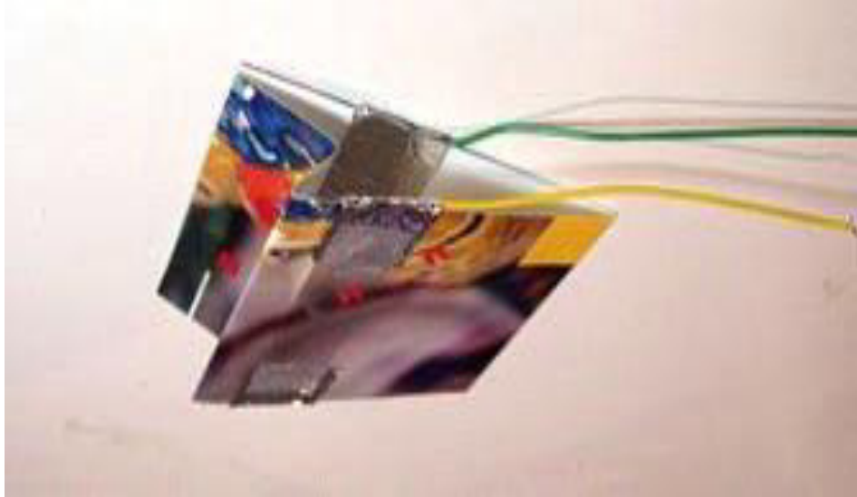
Figura 8 - Sensor de toque com folha de alumínio Fonte: SIPITAKIAT, et. al. 2003.
