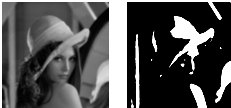
Figura 14: Exemplo da aplicação de limiarização na imagem pós aplicação do filtro. Na esquerda a imagem processada utilizando filtro gaussiano 50x50 e na direita a imagem limiarizada.
