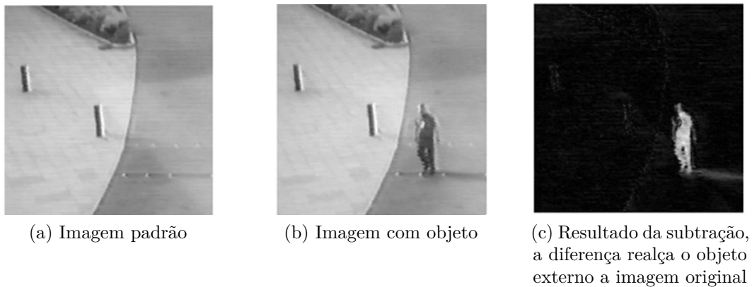
Figura 2: Exemplo de aplicação da subtração de imagens.
