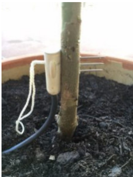
Figura 3.3: Sensor SF3 em experimento (vendido separadamente)
