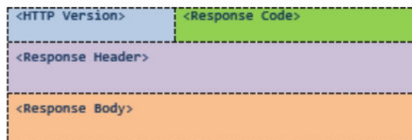
Figura 2.5: Formato de mensagem de resposta REST
