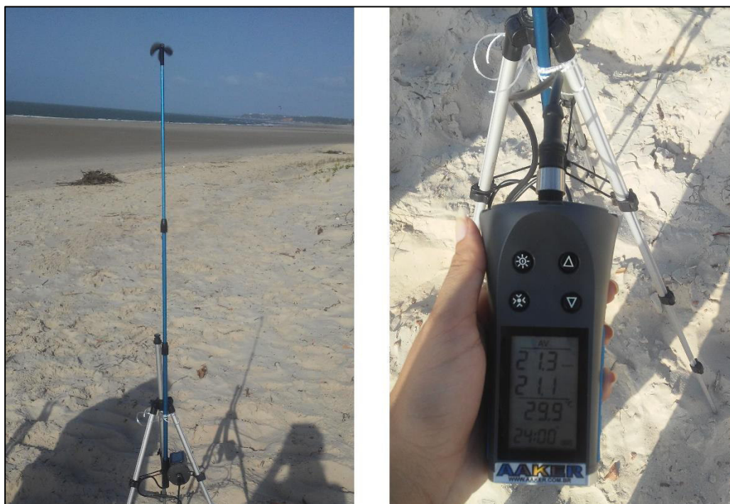
Figura 8: Anemôm para medição da velocidade média do vento.
