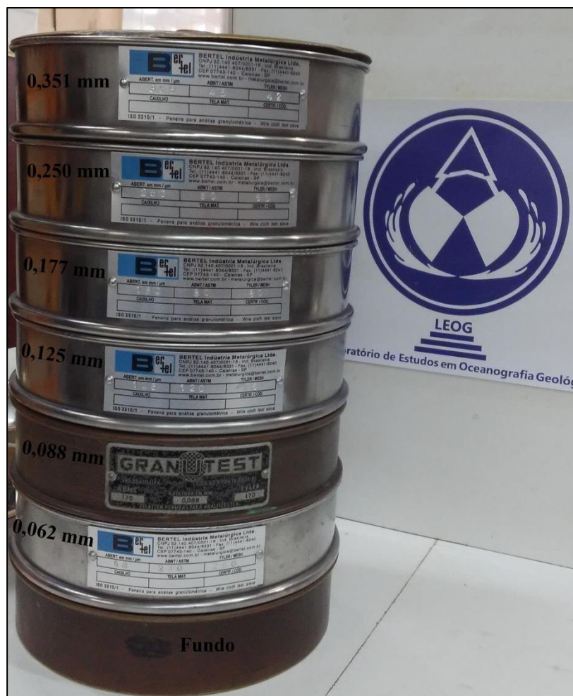
Figura 9: Peneiras para separação dos grãos em intervalo de \frac{1}{2} \phi .
