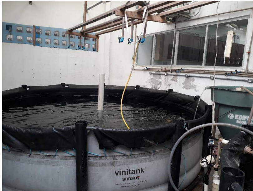
Figura 5. Tanque de 10 m 3 usado no experimento de cultivo de robalo e camurupim no AQUALAB/UFMA, período Set a Dez/2017.
