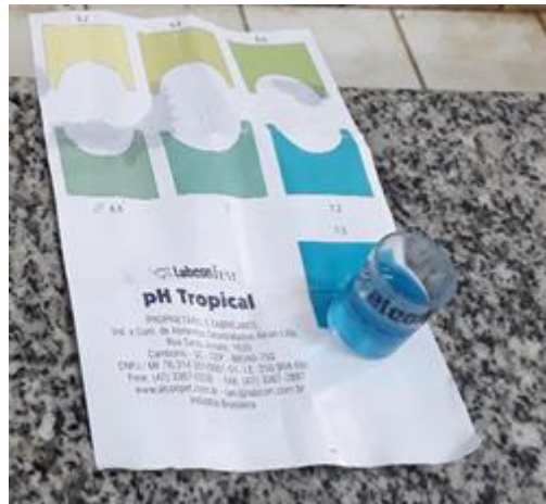
Figura 20: verificação do pH utilizando o método colorimétrico.
