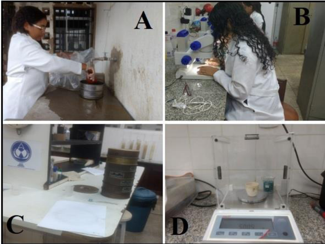
Figura 4. Triagem grosseira (4A), triagem fina e identificação do material biológico (4B) e análise da granulometria (4C) e matéria orgânica (4D).
