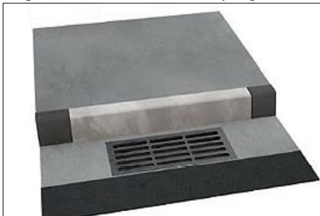
Figura 5 – Boca de lobo tipo grelha
