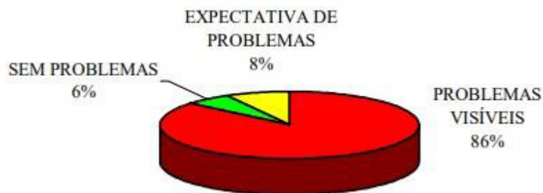
Figura 2 – Incidência de manifestações patológicas associadas à impermeabilização.
