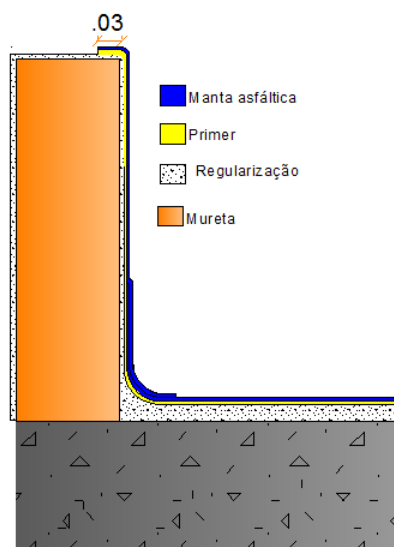
Figura 28 - Encaixe da manta na mureta
