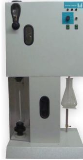
Figura 6: Aparelho analisador de amônia para determinação de nitrogênio total.
