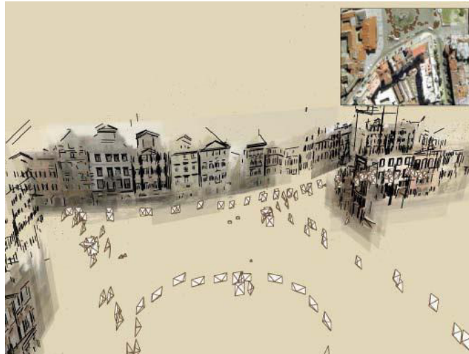
Figura 2.1: Estrutura 3D resultante de algoritmos de reconstrução baseado em centenas de imagens 2D parcialmente sobrepostas. Fonte: Snavely; Szeliski, (2006).
