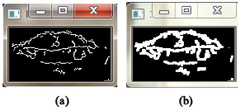
Figura 3.8: Técnicas de Canny (Encontrar Bordas), Erode (Erosão) e Dilate (Dilatação). (a) É a imagem da boca depois da técnica Canny ; (b) É o efeito causado na imagem (a) após ter sido modificada pela sequência de métodos Erode e depois Dilate .
