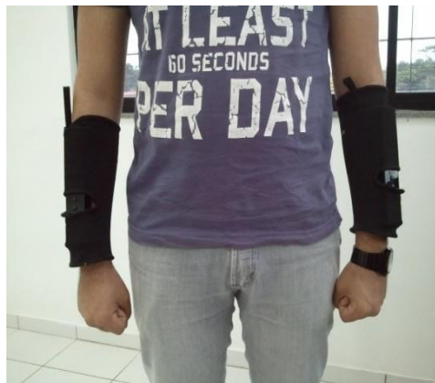
Figura 3.7: Wii mote acoplado aos braços
