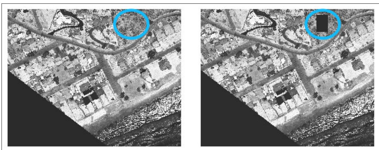
Figura 35 – Imagem LIDAR original extraída à esquerda e editada à direita.
