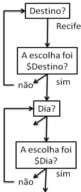
Figura 2.3 – Estrutura de diálogo de um sistema finito baseado em estados
