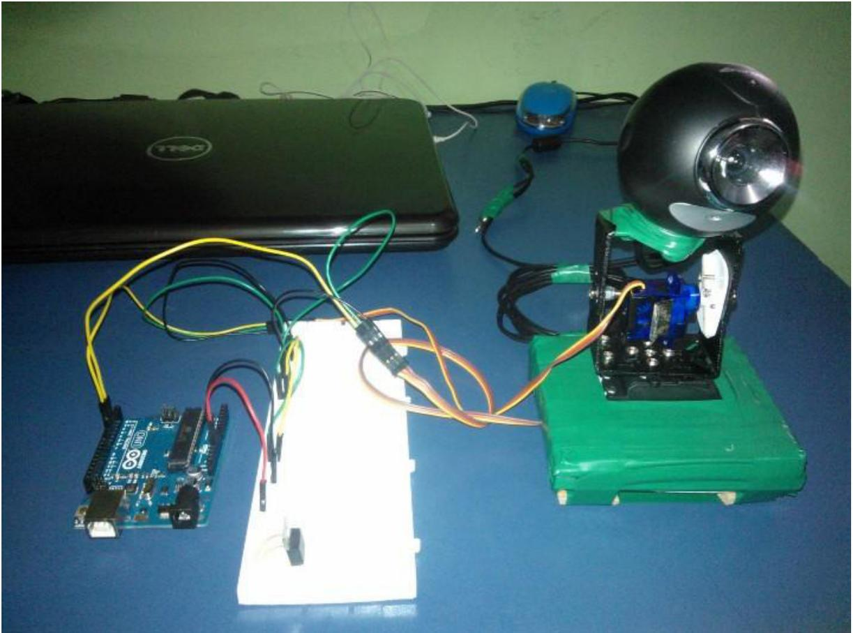
Figura 16 - Circuito com Arduino e Mecanismo Pan-Tilt. Fonte: DANTAS, 2013
