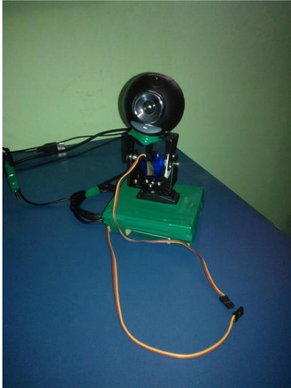
Figura 14 - Mecanismo Pan-Tilt. Fonte: DANTAS, 2013
