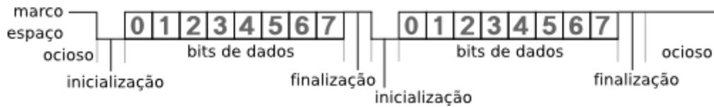
Figura 7 - Comunicação serial assíncrona. Fonte: Wikipedia<sup>5</sup>
