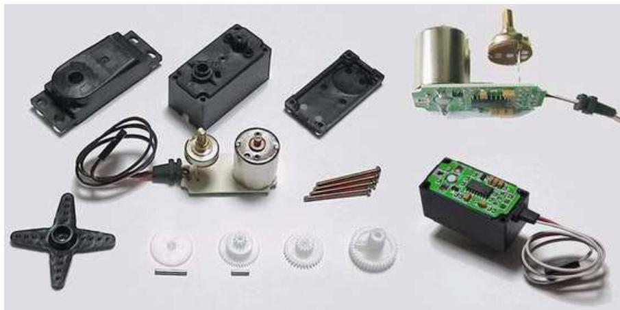
Figura 12 - Servomotor desmontado. Fonte: Servos<sup>13</sup>
