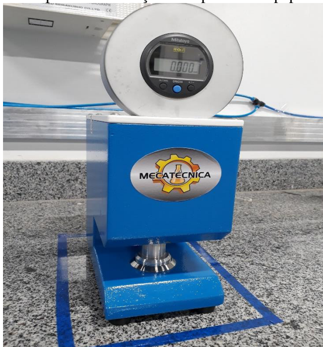
Figura 4 - Micrômetro utilizado para determinação de espessura do papel tissue
