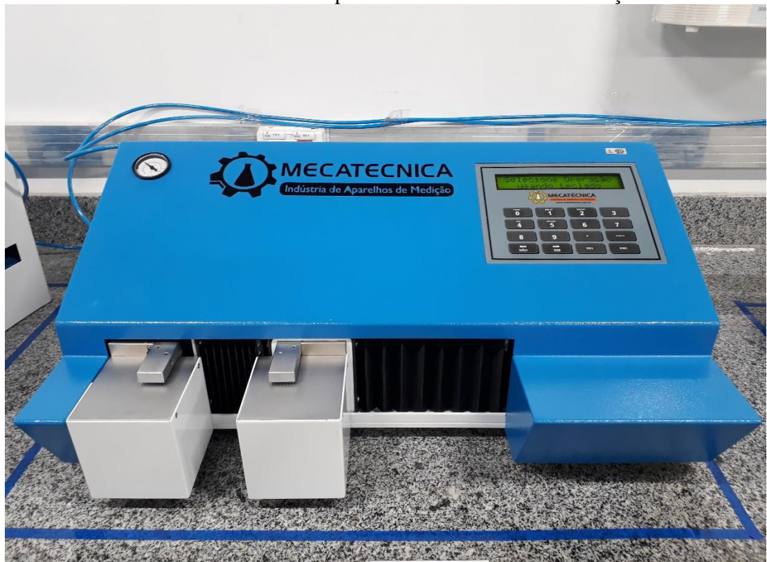
Figura 5 - Dinamômetro horizontal utilizado para ensaios de resistência à tração
