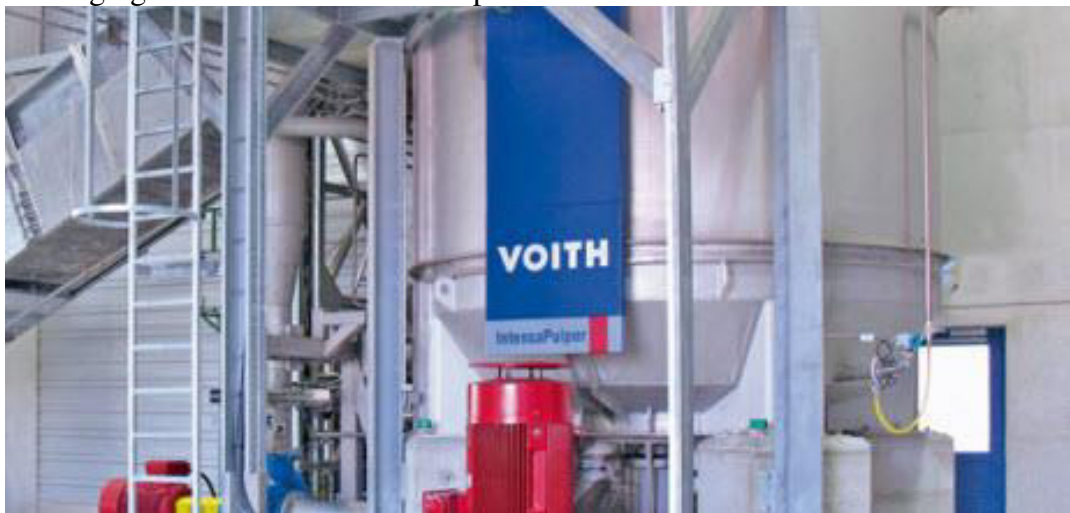
Figura 2 – Desagregador de fibras Intensa Pulper da Voith
