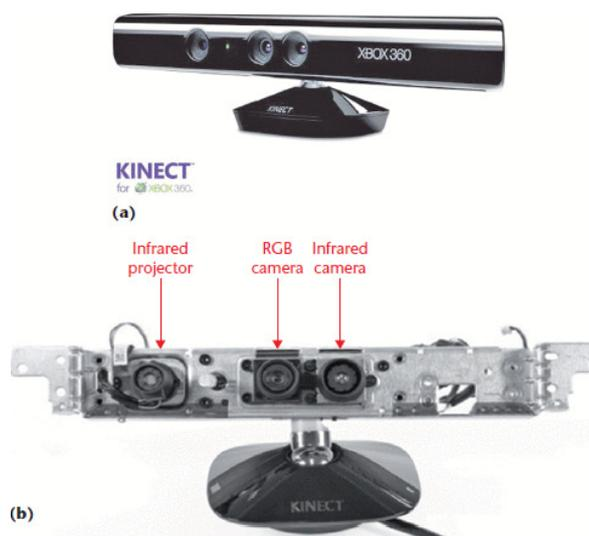
Figura 3 – Imagem detalhando o Kinect. a) Uma foto do *Kinect for Xbox 360* e b) Organização dos sensores do Kinect. Imagem retirada de (ZHANG, 2012).
