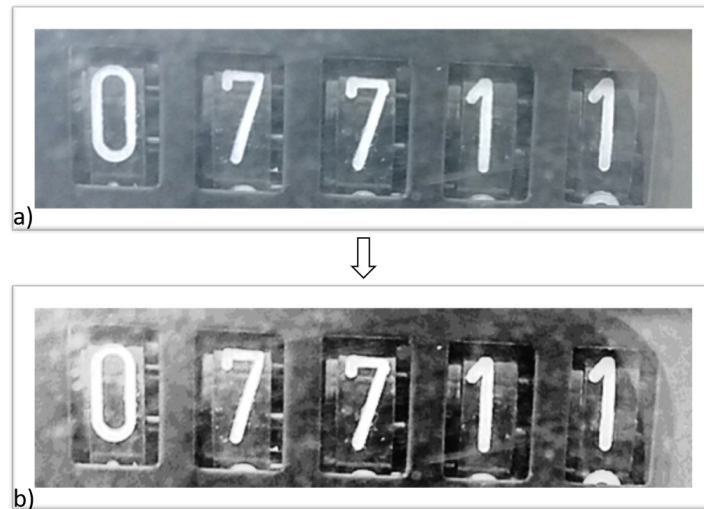
Figura 5 – Resultado da Aplicação: a) imagem original, b) resultado do CLAHE.
