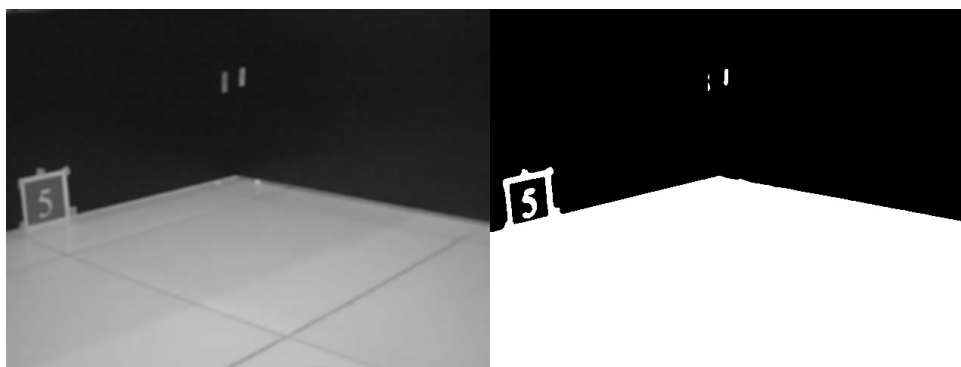
Figura 3 – Aplicação do método otsu. A imagem original em escala de cinza (esquerda) e a imagem binarizada pelo método Otsu (direita).
