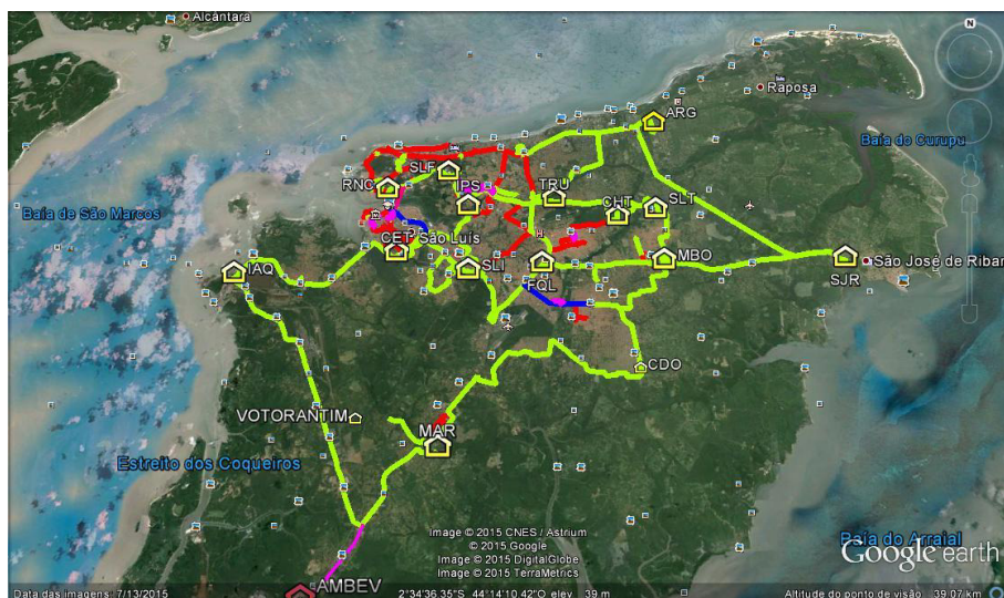
Figura 23 - Rede via fibra óptica entre subestações CEMAR.
