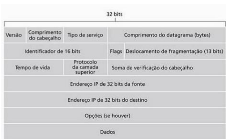
Figura 14 - Ilustração de um datagrama IPv4.
