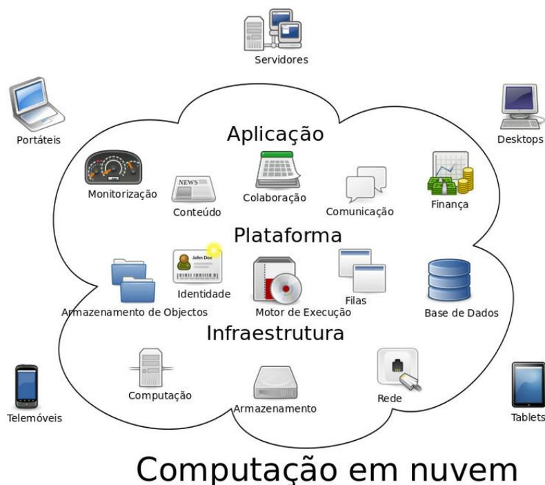
**Figura 2.6:** Figura ilustrativa da nuvem e suas camadas adaptado de [6]
