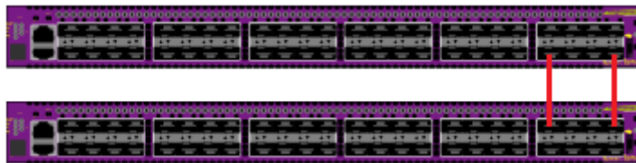
Figura 8.2. Loop entre switches. Fonte: autor.
