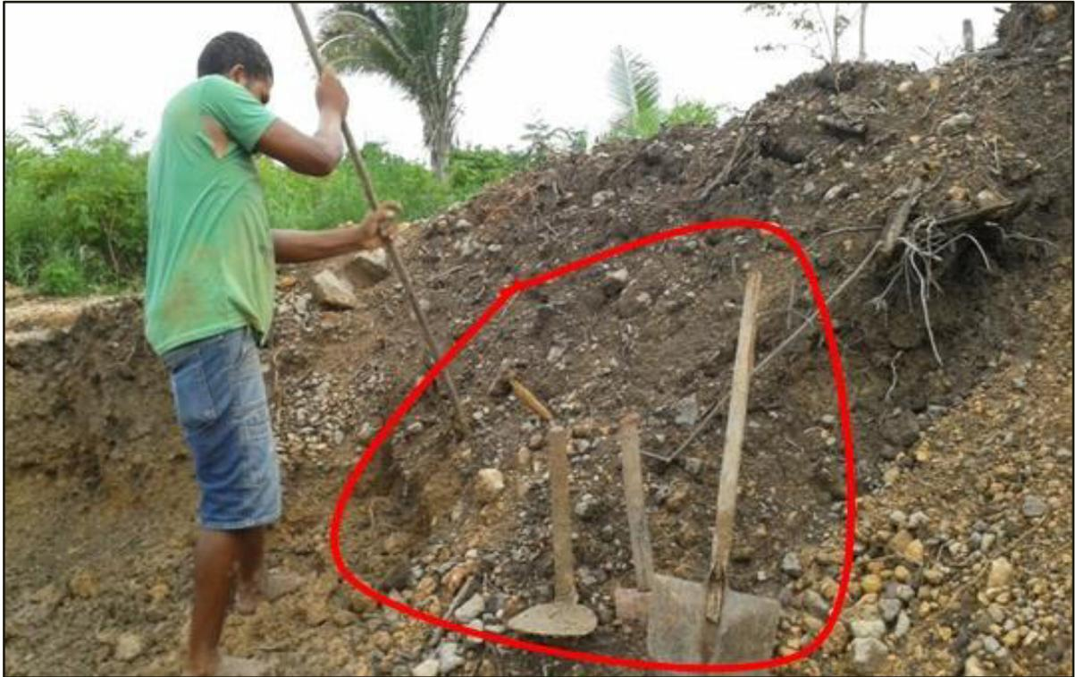
**Figura 6** - Ferramentas utilizadas pelos tiradores de laterita: alavanca, enxada, marreta e pá
