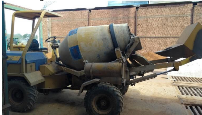
Figura 38 - Mini caminhão betoneira
