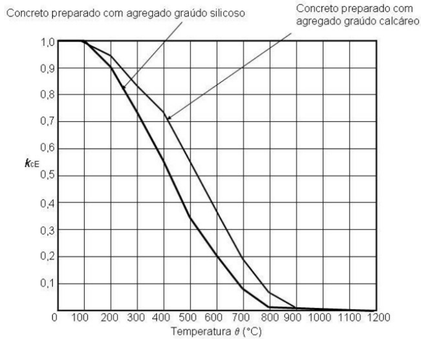
Figura 5 – Fator de redução do módulo de elasticidade do concreto em função da temperatura.
