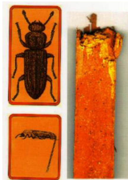
Figura 24 - À esquerda, aspecto do inseto coleóptero Lyctus bruneus adulto, e à direita, aspecto de uma peça de madeira severamente atacada.
