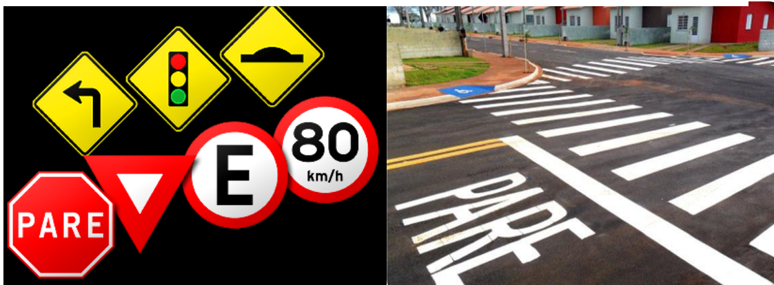
Figura 5- Representação de Sinalização Vertical e sinalização Horizontal
