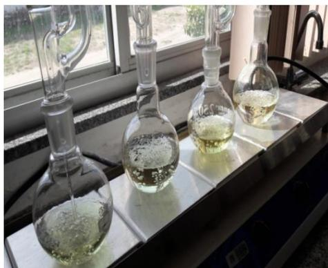
**Figuras 16 e 17 - pesagem da amostra e processo de extração de (EE)**
