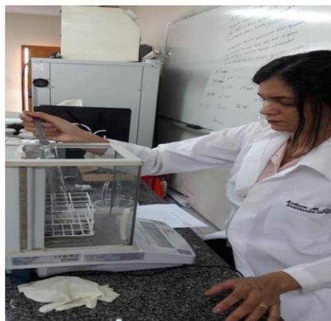
**Figura 7 e 8-** Pesagem da amostra e saquinho (FDN) e pesagem da (PB)
