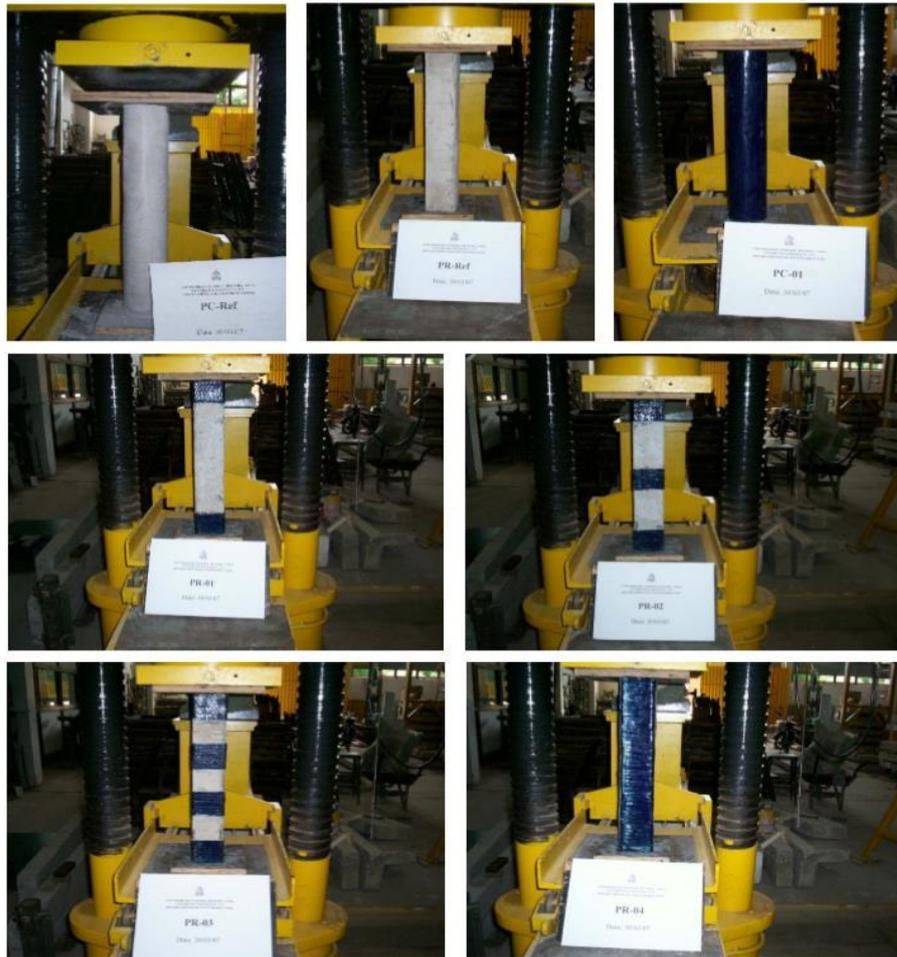
Figura 20: Pilaretes posicionados para ensaio de compressão axial.
