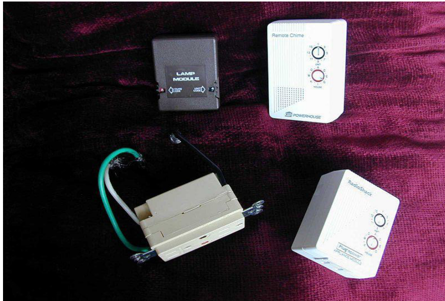
Figura 1 – Módulos X-10 para automação residencial
