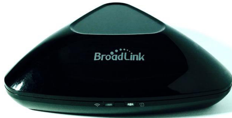
Figura 6 – Central de automação residencial
