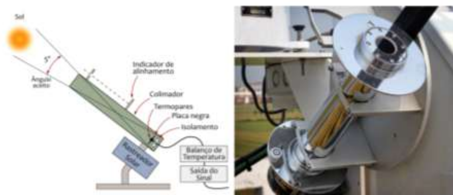
Figura 4 - Representação gráfica e imagem de um Pirheliômetro.
